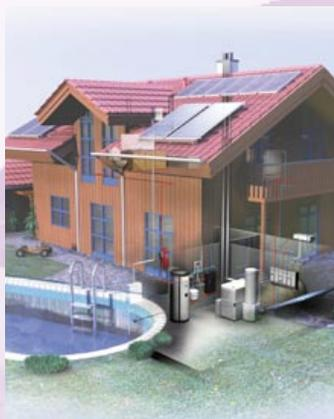
Casa pasivă este un imobil, al cărei consum de energie nu depășește 15 KWh/m<sup>2</sup>/an. Altfel spus, din cauza consumului mic de energie, nu necesită sistem convențional de încălzire. Zidăria de calitate, tâmplăria de calitate, acoperișul termoizolant sunt elemente indispensabile, țelul fiind obținerea unui imobil cu pierdere minimă de căldură.
